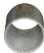
M・H工法による ライニング後の排水管
