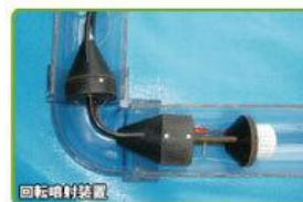
施工後の排水管内部と回転 噴射装置
